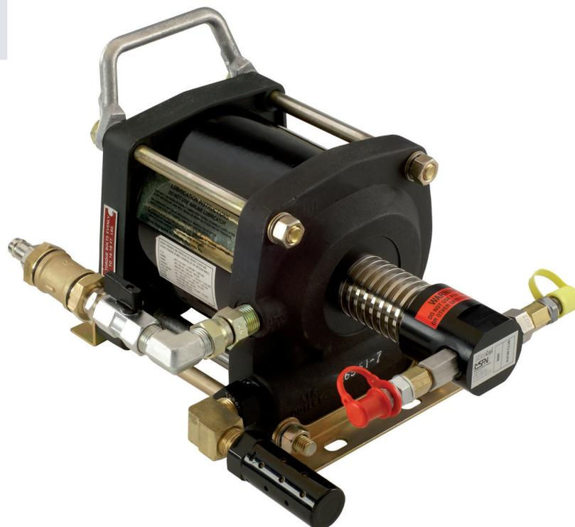
Die Druckeinheit **NCTU.00.016** wurde entwickelt um die Stickstoffflasche, welche zum Befüllen von Gasdruckfedern, Tanks und Tankerplatten benötigt wird, bis auf ein Minimum von ca. 20 bar entleeren zu können.
