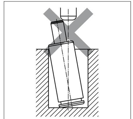
Bei Kavitäten, die tiefer sind als die Feder-Körperlänge, müssen Drainage-Kanäle eingebbracht werden, um so das Überfluten mit Fluiden zu verhindern.
