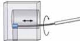
Der Zylinderkopf ist optimal für die Gratentfernung bei Querbohrung in einem Sackloch.
