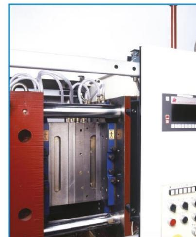
Beim Formenwechsel wird die Form mit den Spannbolzen in die Schnellspannplatte eingeführt, dabei die mit einer Führung versehenen Schließexenter eingeschoben und mit Hilfe eines Schlüssels angezogen. Die Schließexenter sind durch Anschlagstifte geführt und begrenzt.
