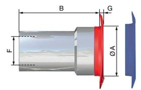
**Buchse gerade mit konischem Außengewinde mit Ventil und selbstdichtender Teflonbeschichtung**
