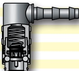
Sichere Verbindung der einzelnen Kupplungsbauteile durch Spezialkleber und zusätzliche FKM-O-Ring-Abdichtung.
