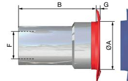
**Buchse gerade mit konischem Außengewinde und selbstdichtender Teflonbeschichtung**
