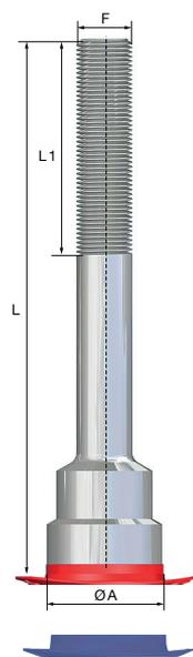
**Buchse mit verlängertem Ansatz: mit zylindrischem Außengewinde**
