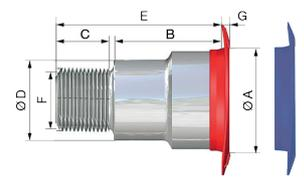
**Buchse gerade mit zylindrischem Innengewinde**
