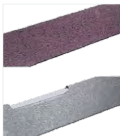
Bild 1: Profil von Dreikantfeilen nach Bearbeitung von gehärtetem Stahl. oben: DEGUSSIT-Feile unten: gebundene Feile
