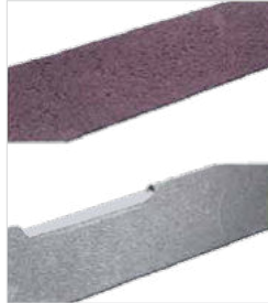
Bild 1: Profil von Dreikantfeilen nach Bearbeitung von gehärtetem Stahl. oben: DEGUSSIT-Feile unten: gebundene Feile
